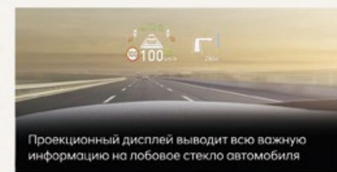
Проекционный дисплей выводит всю важную информацию на лобовое стекло автомобиля
