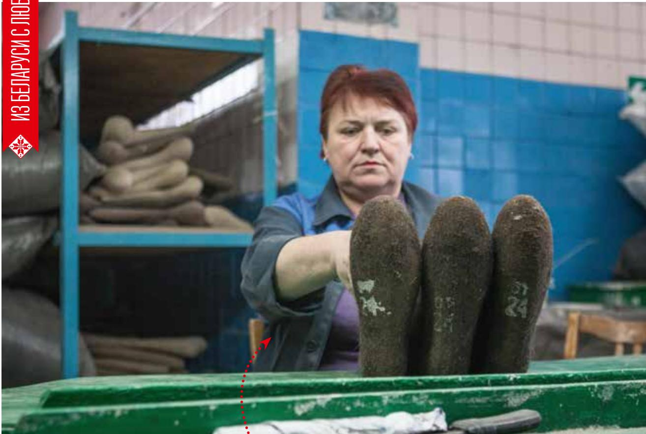
готовую обувь сушат для придания окончательной формы, шлифуют, обрезают до нужной высоты и, наконец, отправляют к «свахам», которые «женят» валенки, подбирая каждому «вторую половинку» по цвету, форме мыска и размеру.
